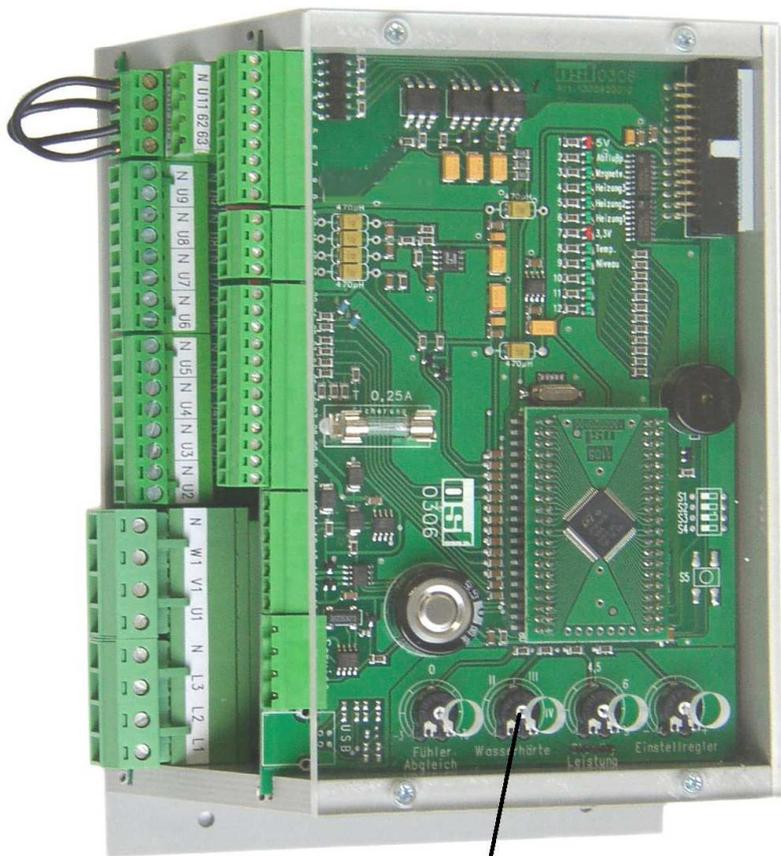
Die Wasserhärte wird mit Hilfe eines kleinen Schraubendrehers an den entsprechenden Einstellregler eingestellt.
