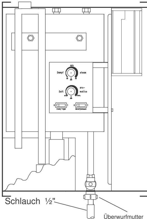
Für den Wasseranschluss ist ein druckfester 1/2“ Waschmaschinen- Anschluss Schlauch mit 90° Winkelanschluss und R3/4“ Gewinde zu verwenden. Dieser Schlauch wird mit Hilfe der daran befindlichen Überwurfmutter an dem Gewindeanschluss des Magnetventils wasserdicht verschraubt.
