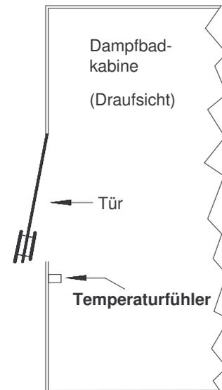
Für die Funktion des Dampfgenerators ist es unbedingt erforderlich, dass beide Drähte des Temperaturfühlers mit den entsprechenden Anschlussklemmen des Dampfgenerators verbunden werden. Ein defekter, nicht angeschlossener, oder überbrückter Temperaturfühler führt zum sofortigen Ansprechen der Sicherheitsschaltung und somit zur Unterbrechung der Dampfproduktion. Für eine evtl. durchzuführende Überprüfung des Temperaturfühlers verwenden Sie bitte die nachstehende Widerstandstabelle.
