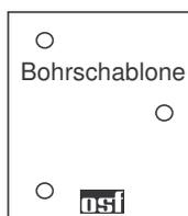
Für die Wandbefestigung verwenden Sie bitte die im Lieferumfang enthaltene Bohrschablone. Der Dampfgenerator darf nur auf einem Untergrund mit ausreichender Tragfähigkeit befestigt werden. Der Dampfgenerator SILVER-STEAM ist seiner Schutzart entsprechend vor Feuchtigkeit geschützt anzubringen.
