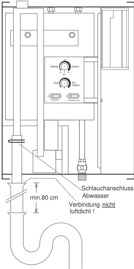
Der Anschluss für das Abwasser erfolgt mittels des mitgelieferten Schlauches am linken Rohrende (siehe Skizze). Die Verbindungsstelle wird mit einer Schlauchschelle fixiert. Mit diesem Schlauch wird die Verbindung zu dem bauseitig fest verlegten Abfluss hergestellt.
