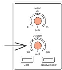
Durch Betätigung dieses Schalters kann der **Abluftventilator** außerhalb der Betriebszeit des Dampfgenerators ein- und ausgeschaltet werden.
